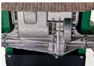
Robustes Getriebe mit integriertem Differential und automatischer Sperre
